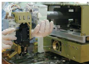
図4 ロボットハンドがフックをつかんだ状態
